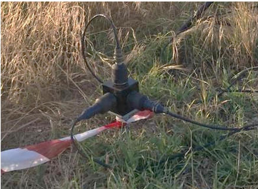
**Figura 1. Postazione montata per la misura delle vibrazioni ambientali in aree non urbane.**
