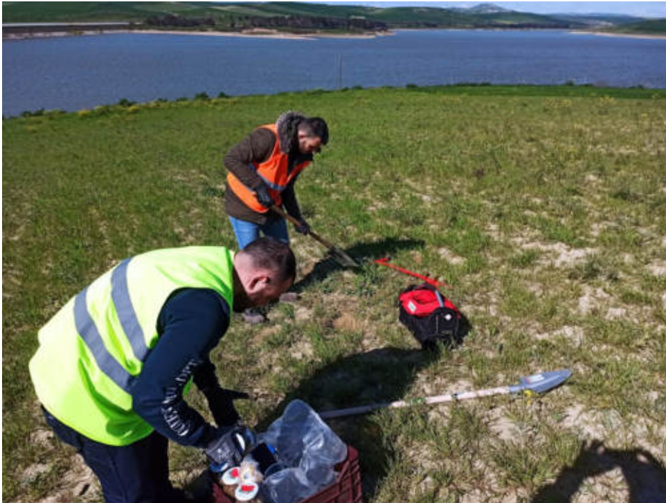
Figura 13. Gravina in Puglia – Diga di Serro del Corvo. Prelievi di campioni ambientali per la definizione preliminare del PGTRS curati dai tecnici di Artea S.r.l..
