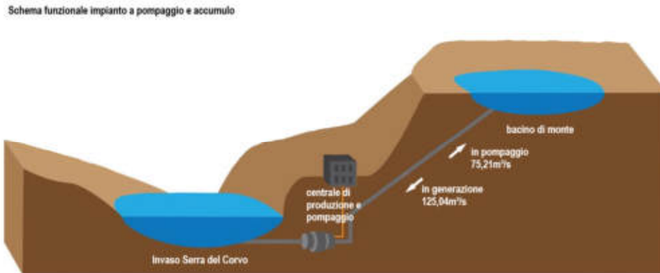
Figura 2. Schema funzionale illustrativo dell'impianto a pompaggio in progetto.
