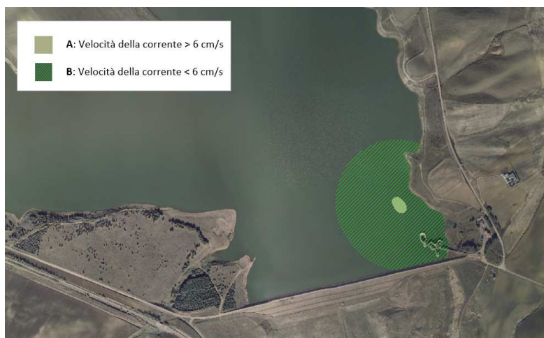
Figura 11. Localizzazione delle zone di alterazione del campo di moto indotte dall'esercizio del nuovo impianto a pompaggio all'interno dell'invaso di Serra del Corvo.
