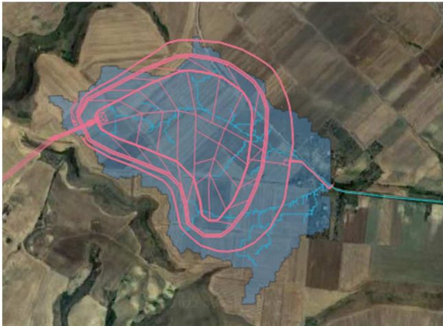
Figura 5. Bacino imbrifero allo stato attuale, in rosa sovrapposizione con il nuovo invaso di monte nello stato post operam.
