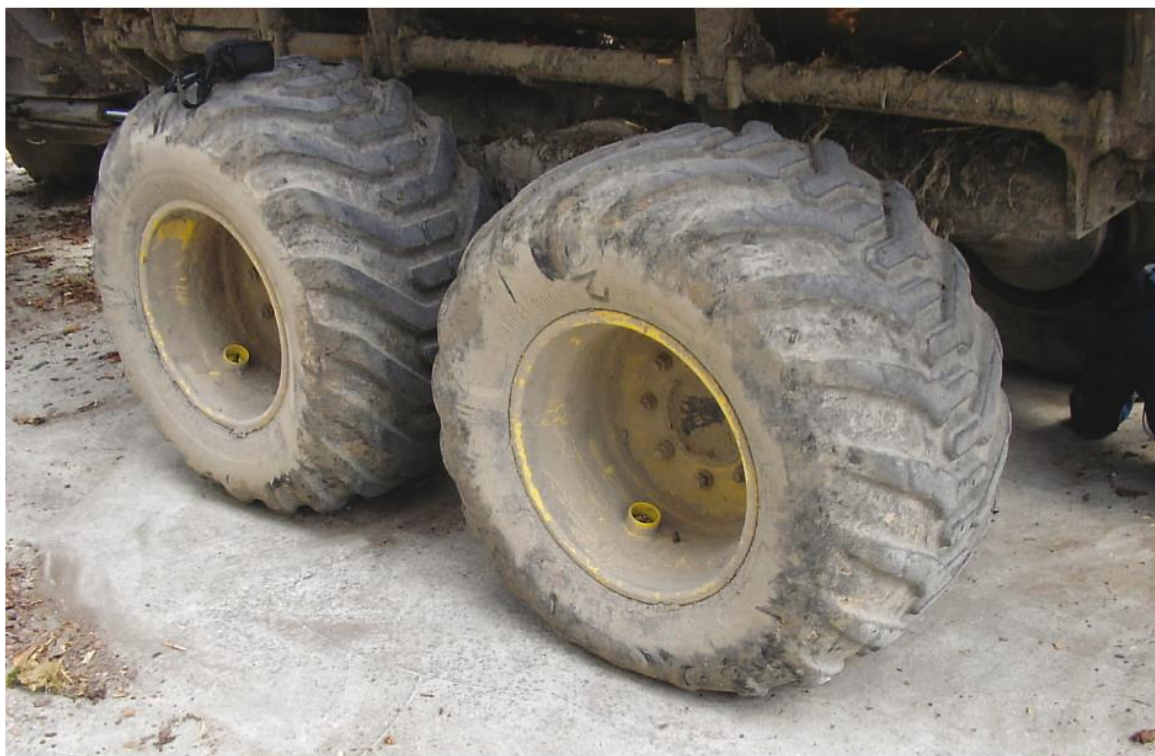
Figura 13: Pneumatici con alta (pneumatico a sinistra) e bassa (pneumatico a destra) pressione di gonfiaggio
