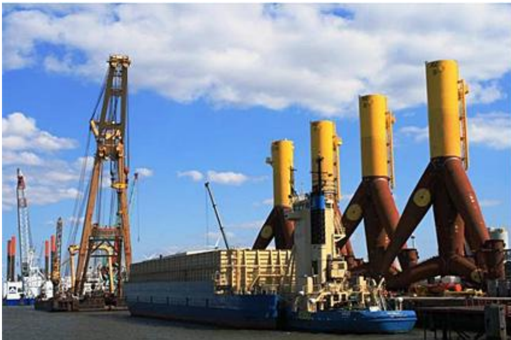
Figura 28 – Stoccaggio delle strutture di fondazioni in porto
