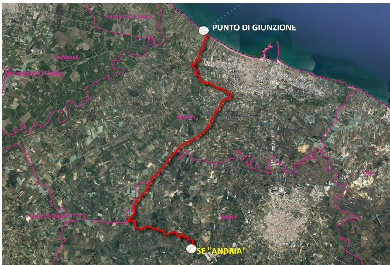
Figura 23 – Ipotesi di percorso cavidotto terrestre interrato
