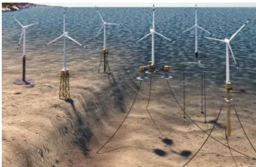
Figura 13 – schema delle tipologie di fondazioni galleggianti - Fonte: USA Energy e Flickr.com
