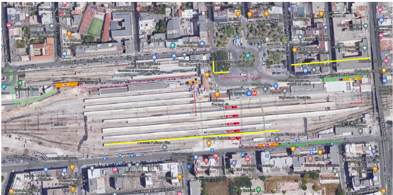
Fig. 22 - Lo schema di seguito individua le barriere antirumore
