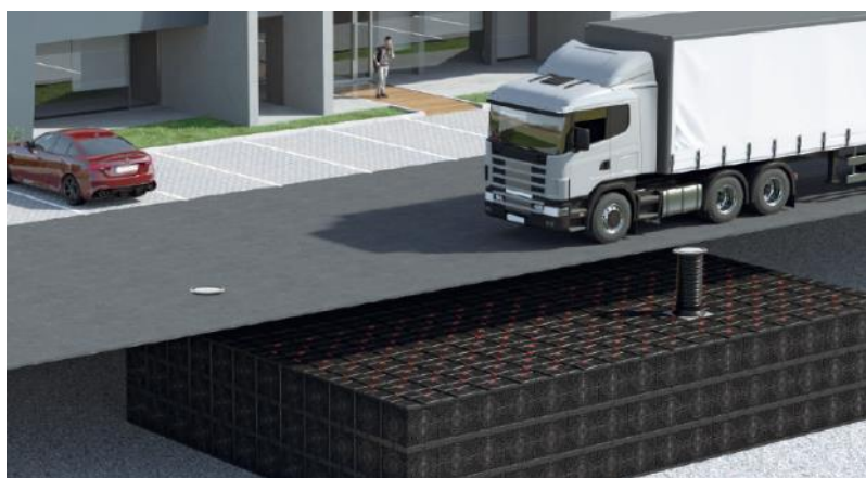
Figura 59: Sistema di accumulo acque per l'irrigazione
