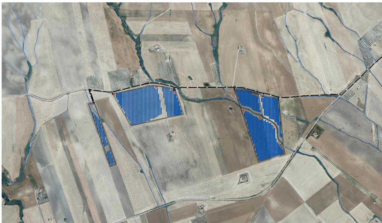
Figura 2.4. – Area di progetto con indicazione del posizionamento dei moduli fotovoltaici.
