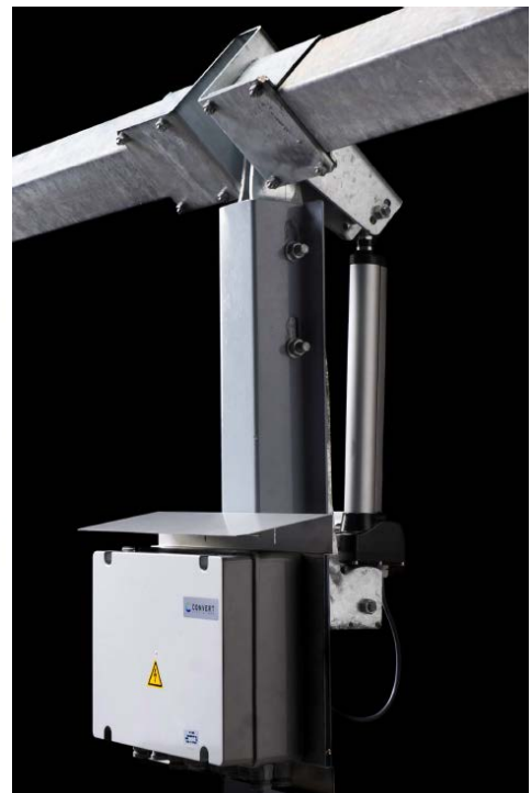
Figura 5 – Sistema di azionamento monoassiale +/- 55° dei Tracker.
