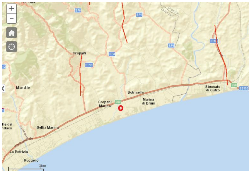
Figura 4-16: Mappa delle faglie 'Capaci' nell'Area circostante il sito della substatione (SGI - ISPRA, 2018) (O Sito)
