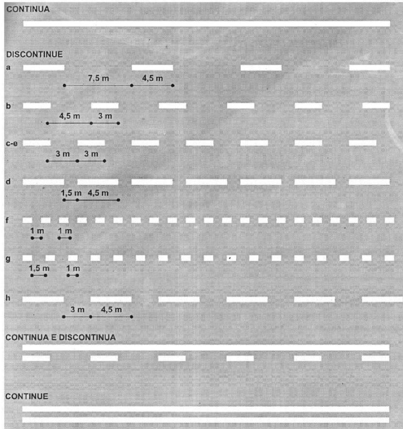
In curva, gli intervalli delle strisce di tipo “a” e “b”, possono essere ridotti in funzione dei raggi di curvatura, fino alla lunghezza del tratto. La larghezza minima delle strisce longitudinali, escluse quelle di margine, è di 15 cm per le autostrade e per le strade extraurbane principali, di 12 cm per le strade extraurbane secondarie, urbane di scorrimento ed urbane di quartiere e 10 cm per le strade locali.
