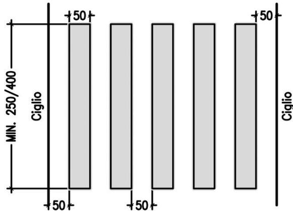
Per quanto riguarda invece gli attraversamenti ciclabili, essi sono evidenziati sulla carreggiata mediante due strisce bianche discontinue, di larghezza 50 cm, con segmenti ed intervalli lunghi 50 cm; la distanza minima tra i bordi interni delle due strisce è trasversali è di 1 m per gli attraversamenti a senso unico e di 2 m per gli attraversamenti a doppio senso.
