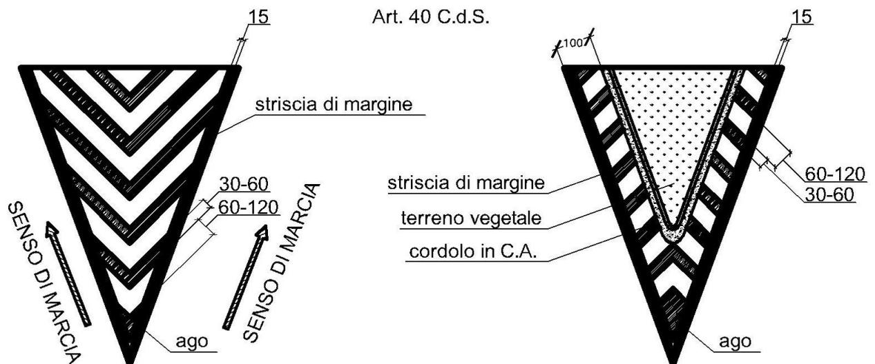
Le strisce delle zebraure devono essere di colore bianco, inclinate di almeno 45° gradi rispetto alla corsia di marcia e di larghezza non inferiore a 30 cm; gli intervalli tra le strisce sono di larghezza doppia rispetto alle strisce. La distanza tra la striscia di margine e la banchina è di 1 m, negli innesti delle rotatorie la distanza si riduce a 50 cm. Quando la distanza tra le strisce è inferiore a 50 cm la zebraura è continua (ago).
