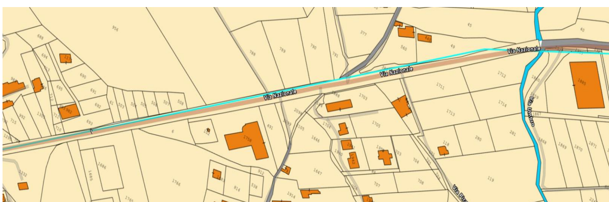
Figura 3:18: Cavidotto AT su catastale – Tratto 15
