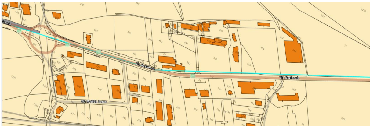
Figura 3:14: Cavidotto AT su catastale – Tratto 11
