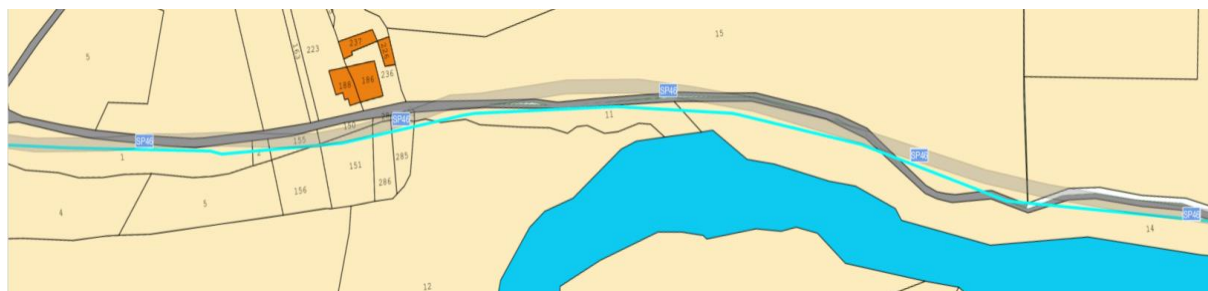
Figura 3:51: Cavidotto AT su catastale – Tratto 48
