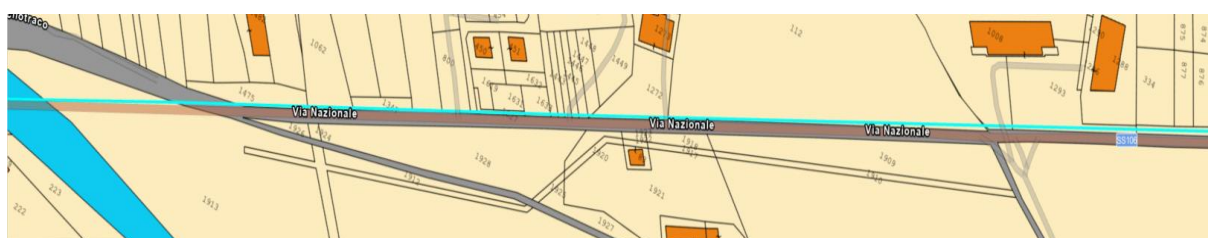
Figura 3:12: Cavidotto AT su catastale – Tratto 9
