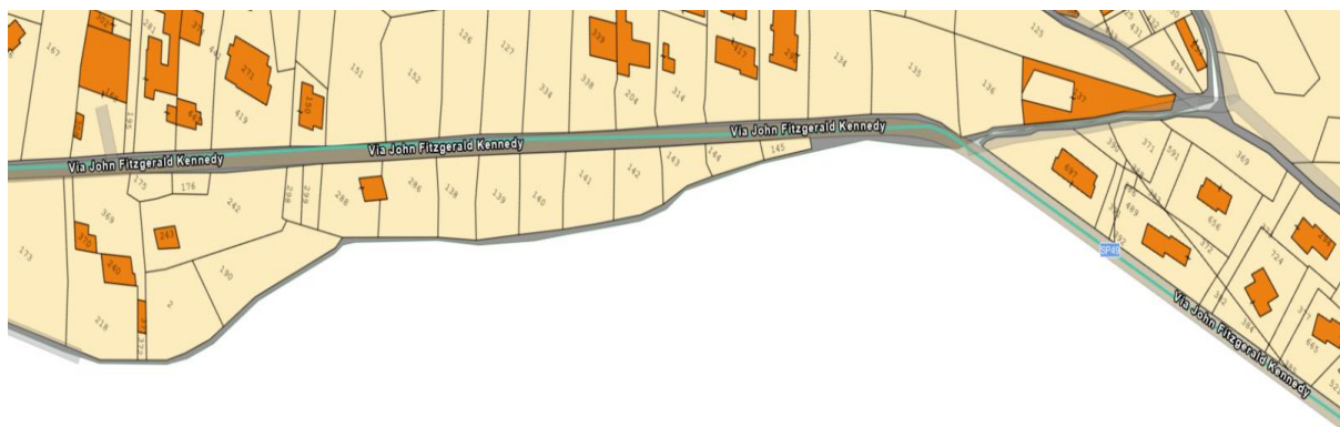
Figura 3:63: Cavidotto AT su catastale – Tratto 60
