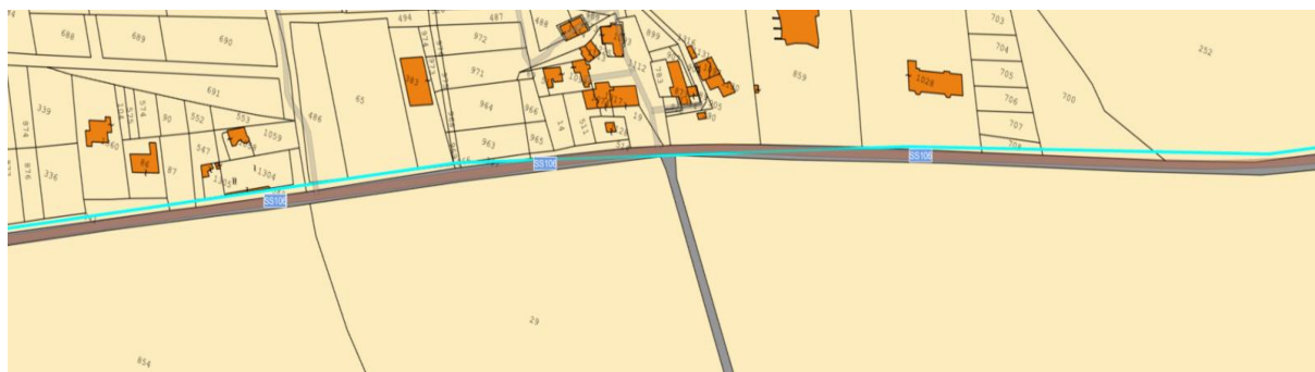
Figura 3:11: Cavidotto AT su catastale – Tratto 8
