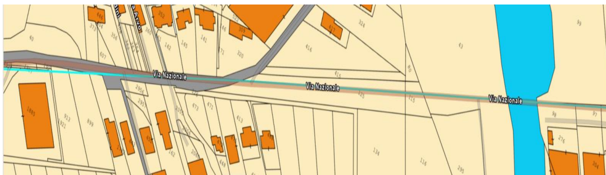
Figura 3:17: Cavidotto AT su catastale – Tratto 14
