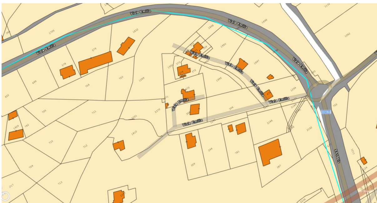
Figura 3:31: Cavidotto AT su catastale – Tratto 28
