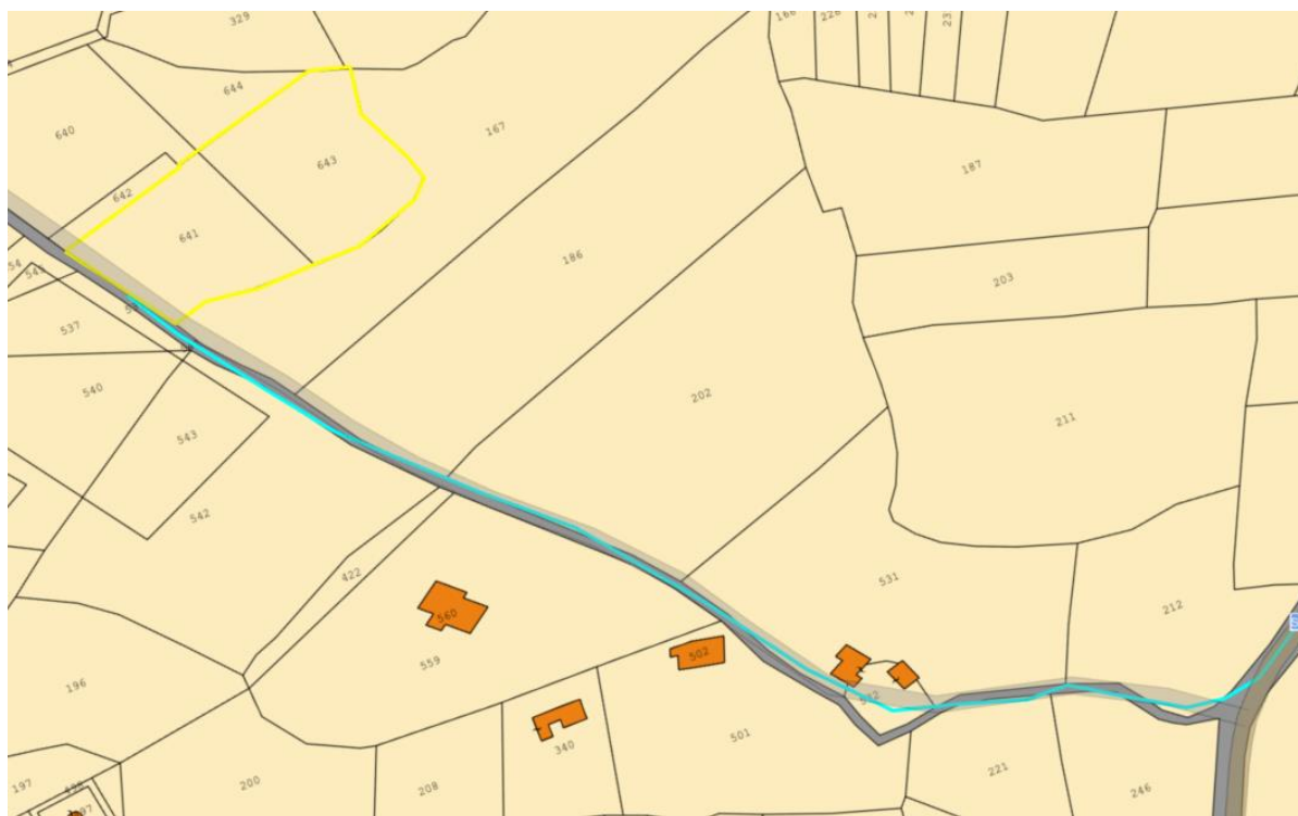
Figura 3:66: Cavidotto AT su catastale – Tratto 63
