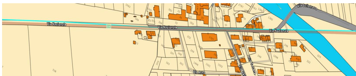
Figura 3:13: Cavidotto AT su catastale – Tratto 10
