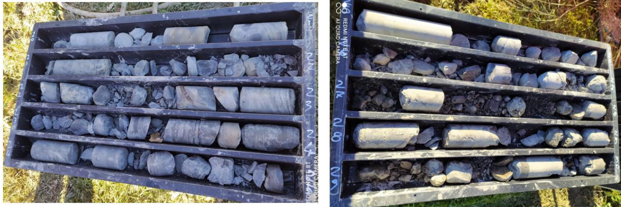
Sondaggio S5 – Cassetta C5 da 20,00 a 25,00 m di profondità dal p.c.
