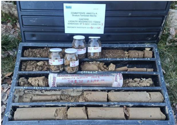
Sondaggio S3 – Cassetta C1 da 0,00 a 5,00 m di profondità dal p.c.
