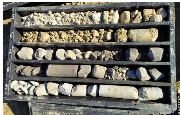
Sondaggio S2 – Cassetta C2 da 5,00 a 10,00 m di profondità dal p.c.
