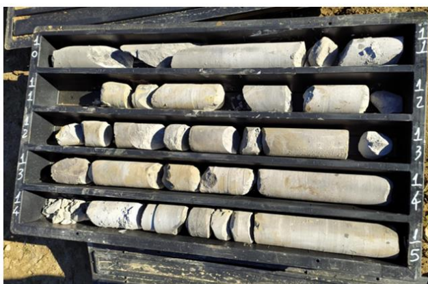
Sondaggio S2 – Cassetta C3 da 10,00 a 15,00 m di profondità dal p.c.
