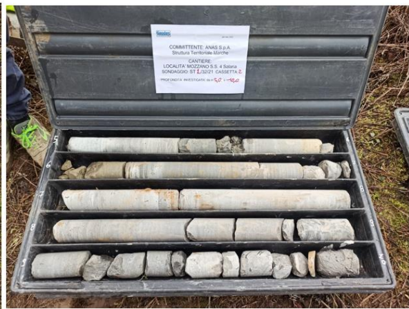
Sondaggio S1 – Cassetta C2 da 5,00 a 10,00 m di profondità dal p.c.
