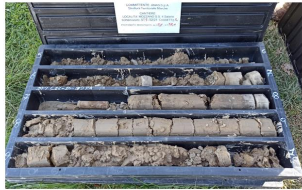
Sondaggio S5 – Cassetta C2 da 5,00 a 10,00 m di profondità dal p.c.
