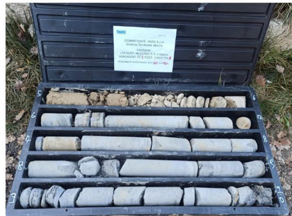
Sondaggio S3 – Cassetta C2 da 5,00 a 10,00 m di profondità dal p.c.
