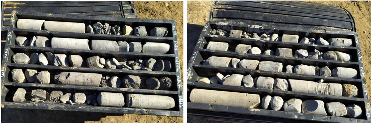
Sondaggio S2 – Cassetta C6 da 25,00 a 30,00 m di profondità dal p.c.
