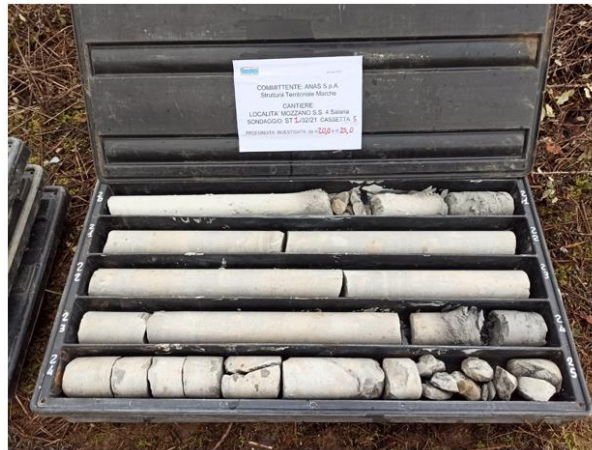
Sondaggio S1 – Cassetta C5 da 20,00 a 25,00 m di profondità dal p.c.
