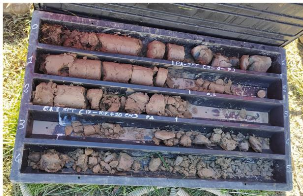
Sondaggio S5 – Cassetta C1 da 0,00 a 5,00 m di profondità dal p.c.
