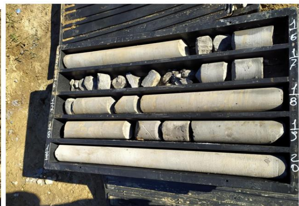
Sondaggio S2 – Cassetta C2 da 5,00 a 10,00 m di profondità dal p.c.
