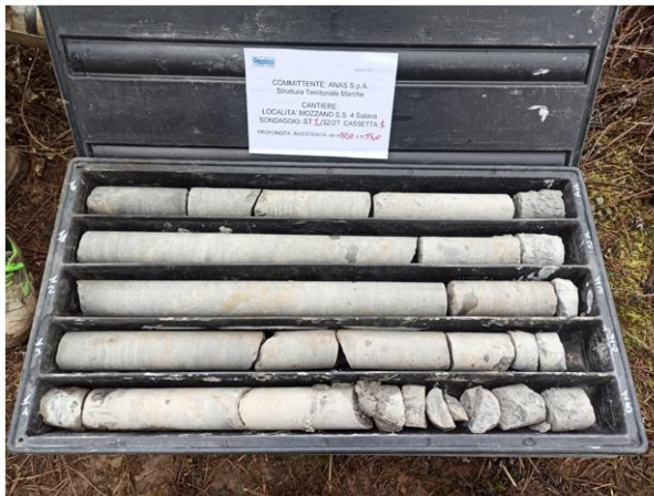
Sondaggio S1 – Cassetta C3 da 10,00 a 15,00 m di profondità dal p.c.
