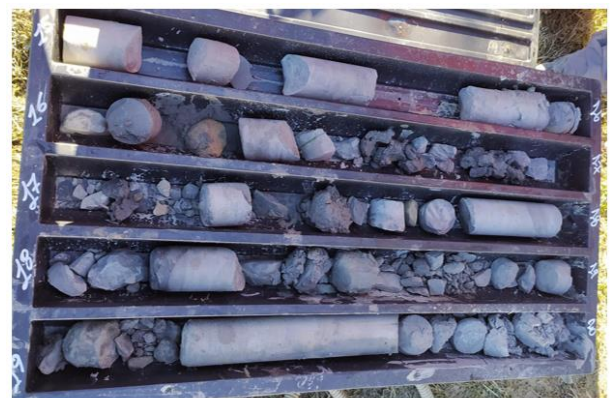
Sondaggio S5 – Cassetta C4 da 15,00 a 20,00 m di profondità dal p.c.
