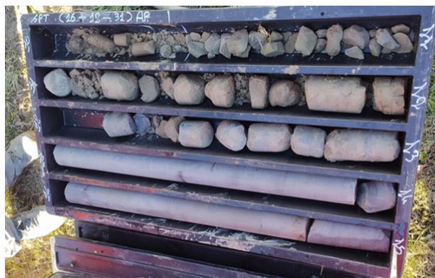
Sondaggio S5 – Cassetta C3 da 10,00 a 15,00 m di profondità dal p.c.
