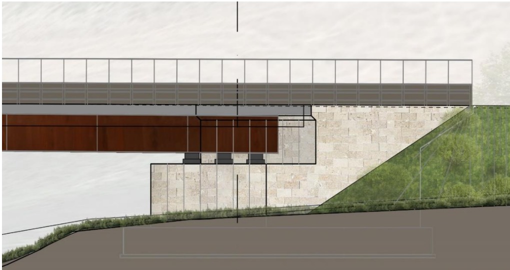
Figura 28 – Rivestimento spalle Ponte Fluvione
