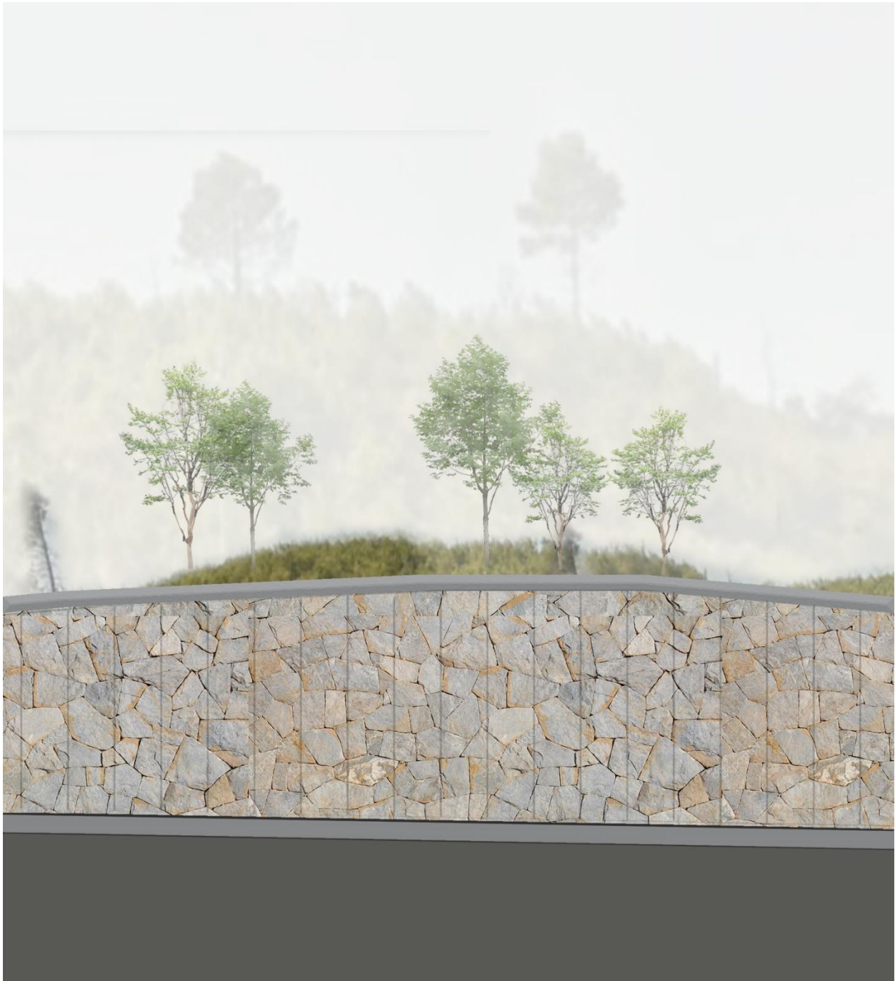
Figura 30 –Particolare Opera di Sostegno Ipotesi A
