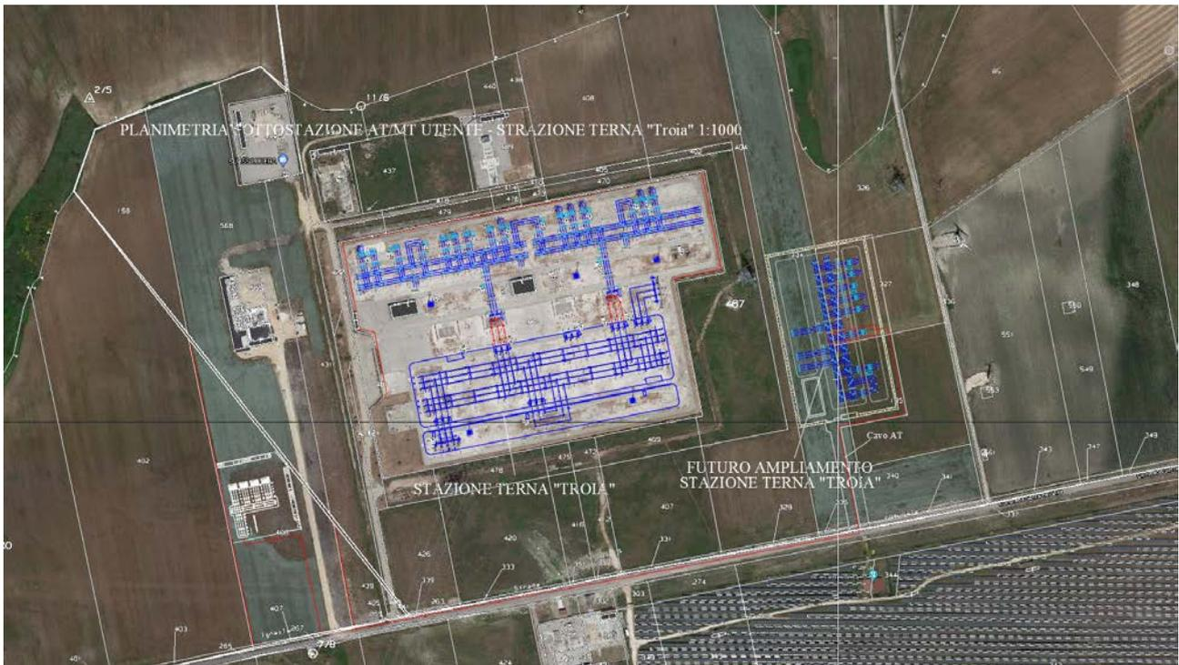
**Figura 3- Ampliamento SE e ubicazione stazione elevazione AT/MT**
