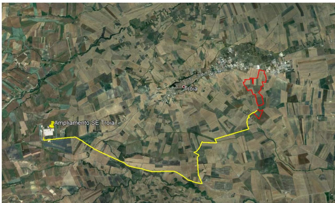
Figura 9- Tracciato cavidotto MT esterno verso ampliamento SE Troia
