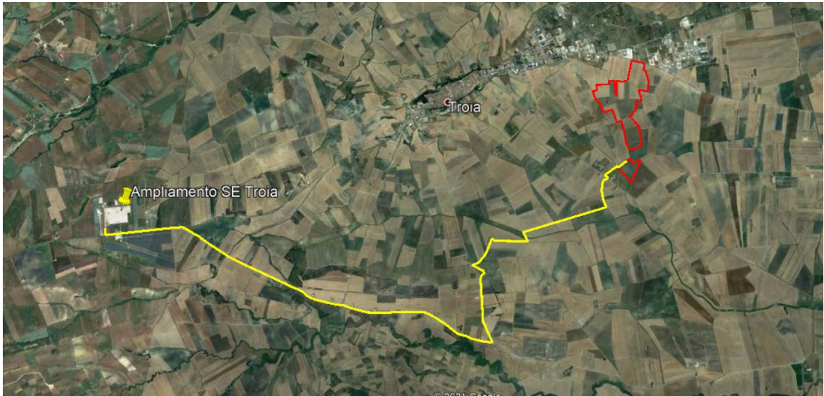
Figura 1b- Tracciato MT verso ampliamento SE Troia
