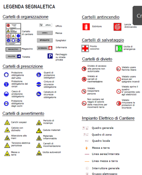
Figura 76- Segnaletica di cantiere
