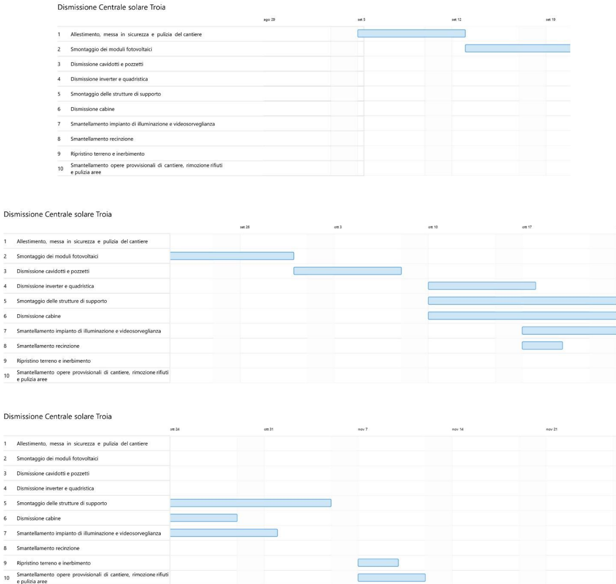
Figura 77 - Cronogramma opere di dismissione cantiere, 1, 2, 3
