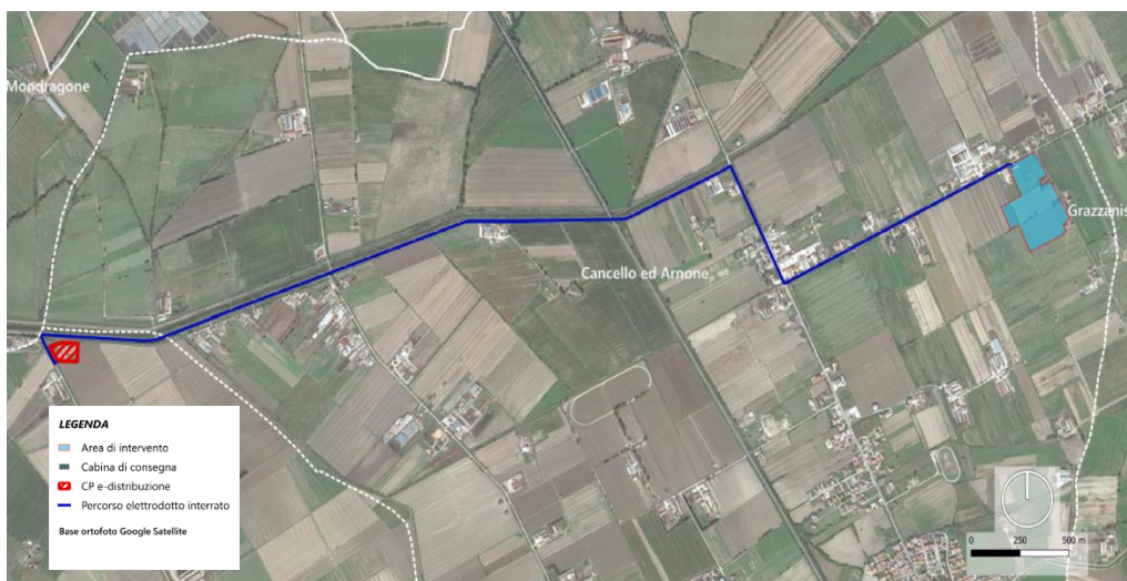
Fig. 1 - Inquadramento su Ortofoto con evidenziato l'area di intervento, il percorso del cavidotto e la cabina primaria AT/MT.
