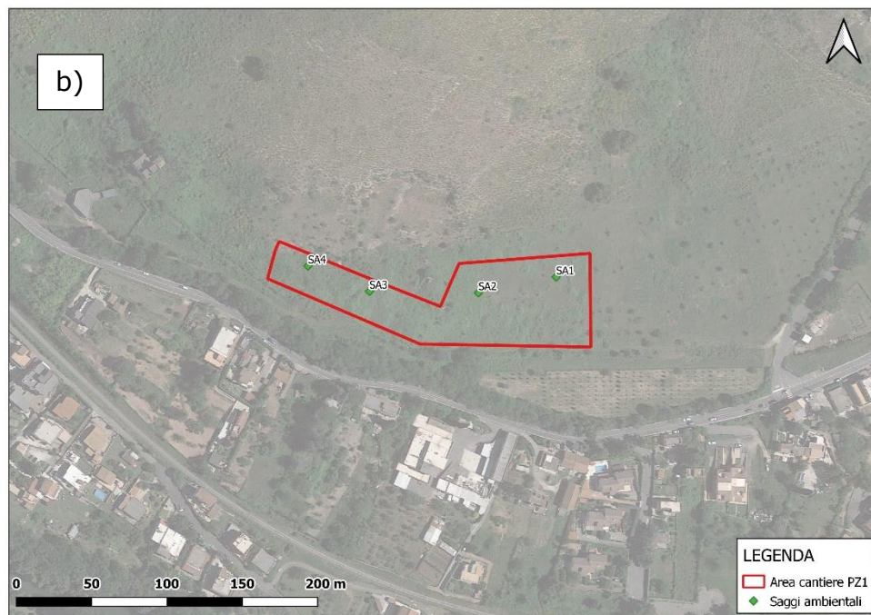
Figura 4-1 Ubicazione dei punti di indagine su base C.T.R. 5000 (a) ed immagine satellitare (b). In rosso l'area di cantiere PZ1, in verde l'ubicazione dei saggi ambientali
