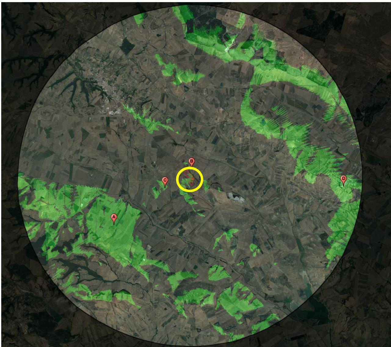
Figura 40. Mappa di intervisibilità dell'impianto. In verde, le aree da cui è possibile vedere il parco, il cerchio in giallo individua l'area impianto e i segnaposto i punti di vista significativi presi all'interno delle aree di intervisibilità.
