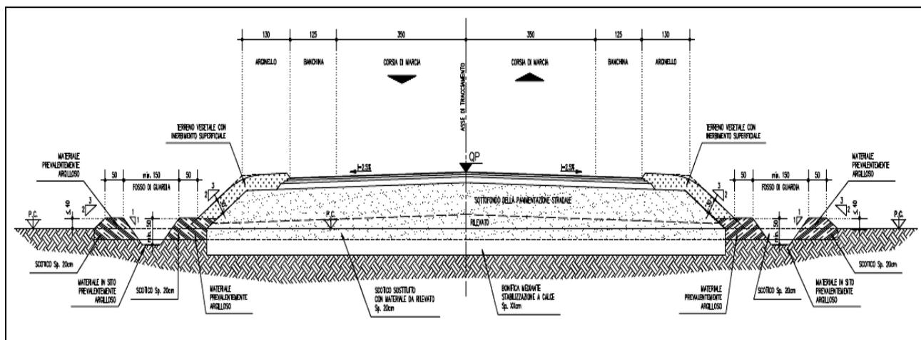
FIGURA 3.1.2 – SEZIONE TIPO STRADA PROVINCIALE RIGA DI NUOVA PROGETTAZIONE
