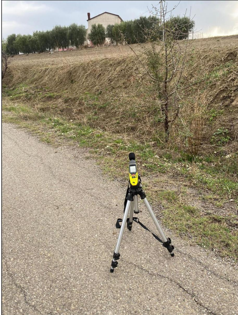
*Figura 3 - Recettore R2 – Riprese fotografiche durante i rilievi fonometrici eseguiti in sito*
