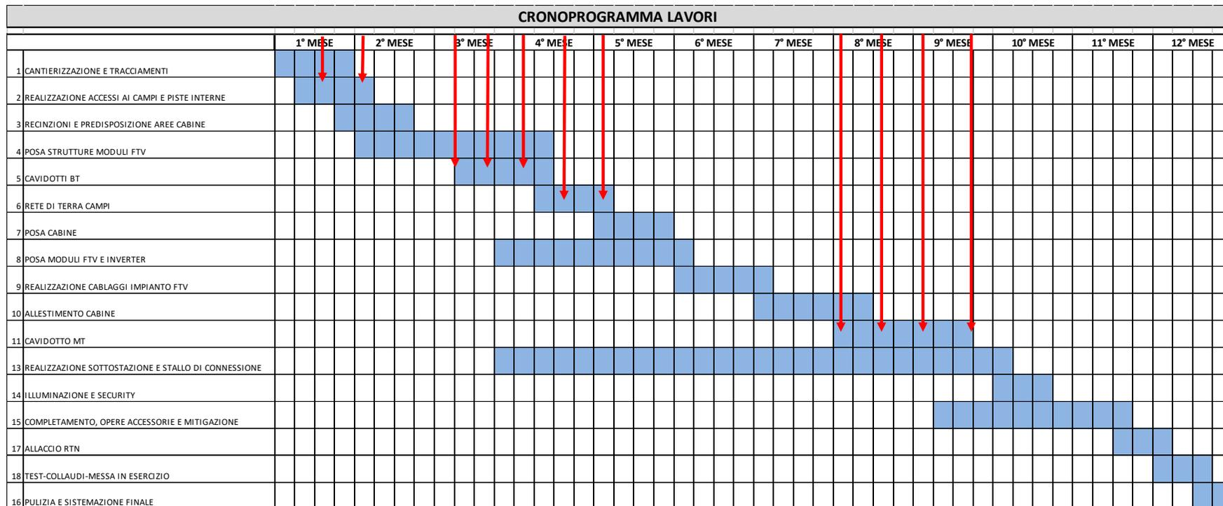
Figura 4 - Individuazione delle sessioni di misurazione sulla componente atmosferica in concomitanza delle fasi ritenute più critiche in cantiere (Fonte: ns elaborazione)
