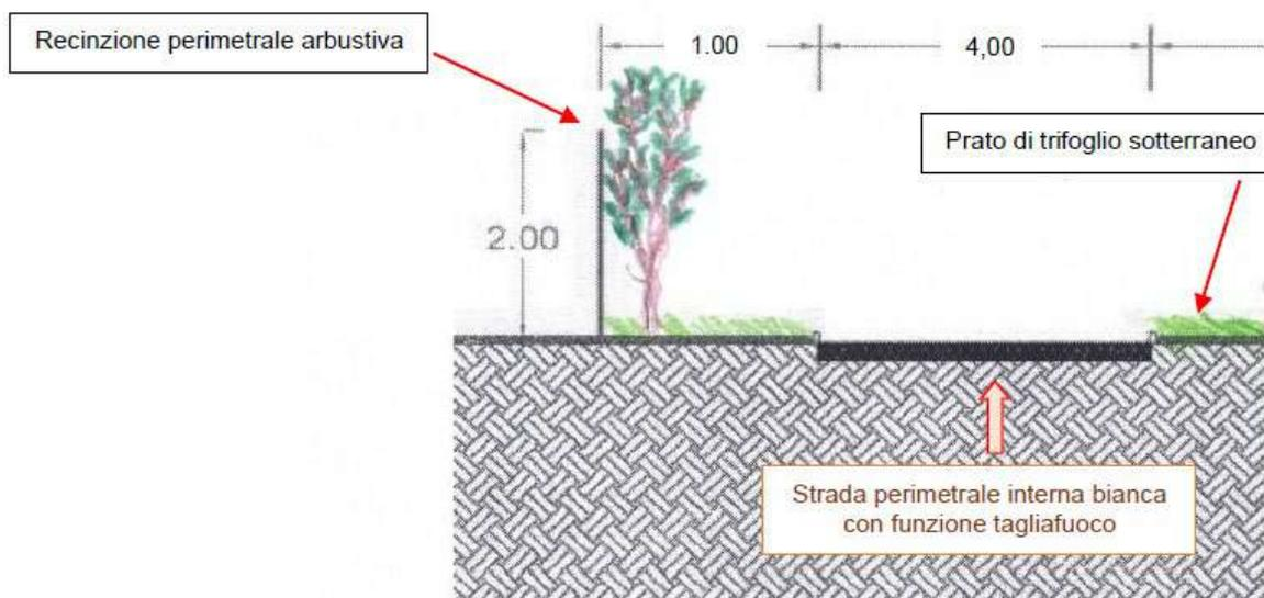
Figura 12.2. – Stralcio di sezione dell'area perimetrale dell'impianto.
