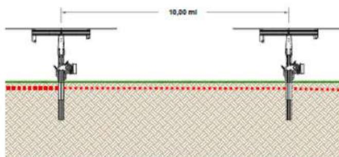
Figura 12.1. – Distanza tra le singole file (tracker) di moduli fotovoltaici con indicazione della superficie che può essere utilizzata per la messa a coltura del prato stabile (linea rossa tratteggiata).
