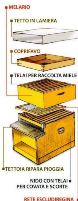
Figura 3.2. – Schema tipo componenti arnia.
