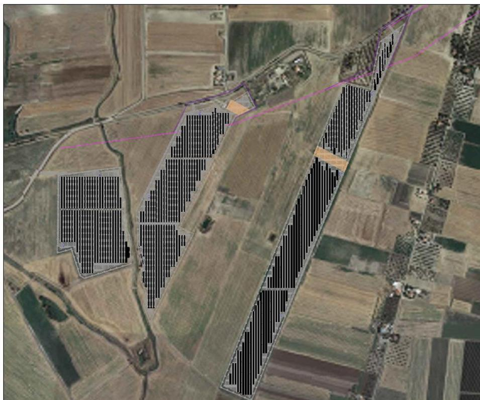
Figura 16: Interferenza Elettrodotti e Gadotti, con relative fasce di rispetto
