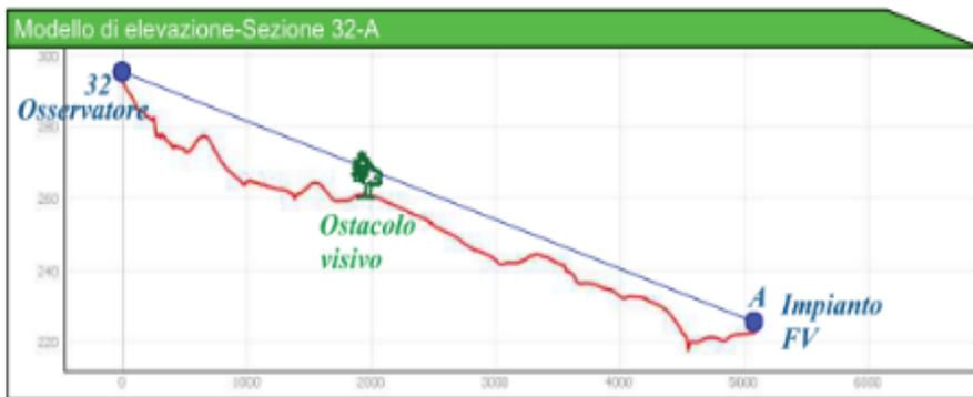
Figura 94 Modello di elevazione Sezione 32-A
