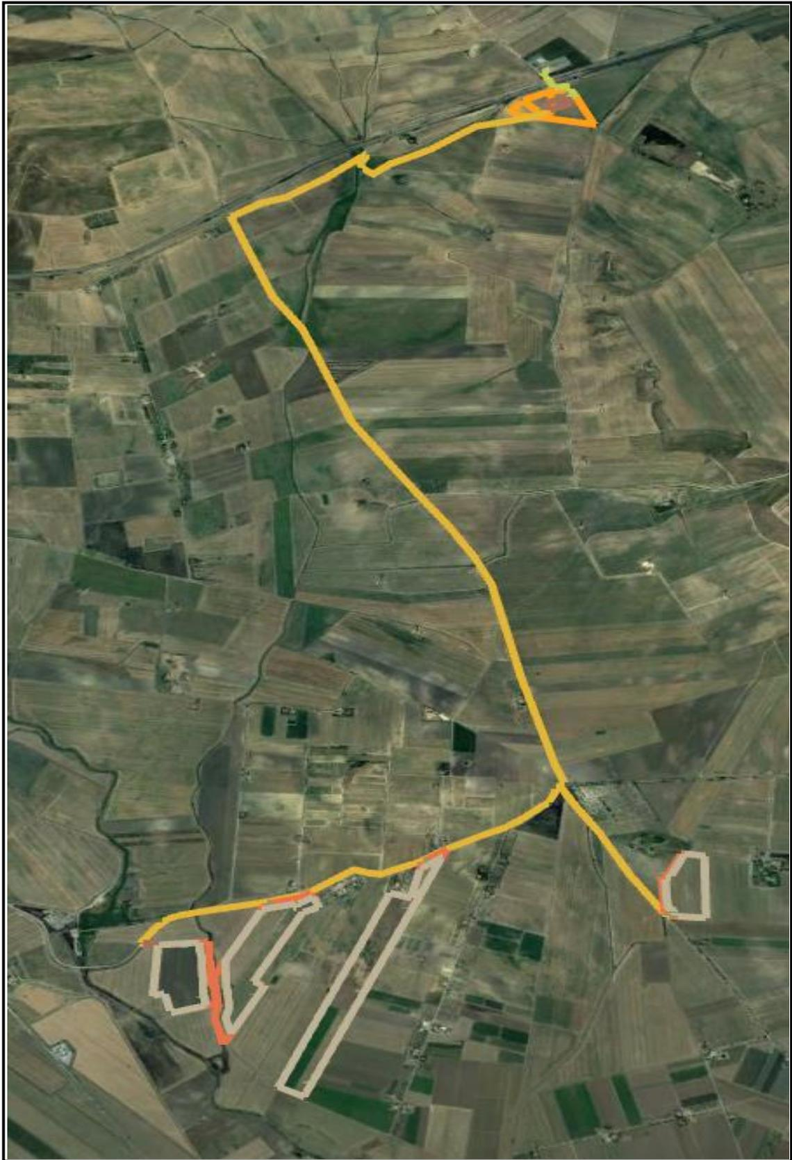
**Figura 1** Area d'impianto con moduli fotovoltaici, cavidotto (in giallo), sottostazione (in arancio) e stazione elettrica
