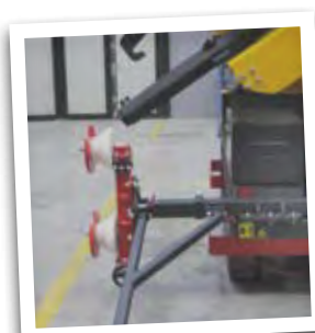
2010 - Battipalo ORTECO FEX studiato per impianti di fotovoltaico
