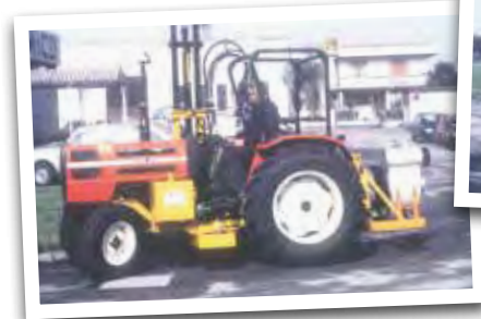
1985 - Applicazione speciale: batteripalo per trattore agricolo con compressore d'aria
