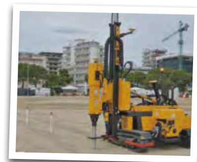
2016/2017 - Creati n° 2 nuovi modelli di batteripalo: ORTECO HD High Power 1500 e ORTECO Sun. 4.0 ("battipalo da spiaggia"). Progettata colonna per pali di lunghezza totale 5 mt da applicare al modello HD 1000 cingolato
