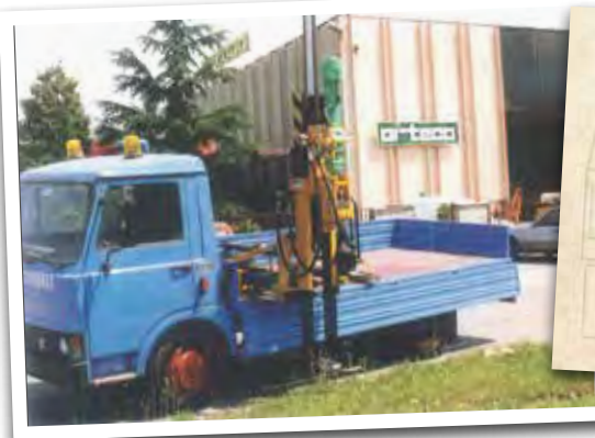
1985 - Applicazione speciale: batteripalo per trattore agricolo con compressore d'aria
