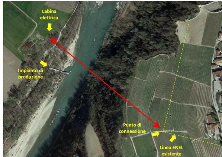
**Figura 55 – Collocazione dell'impianto di produzione e del punto di connessione.**
