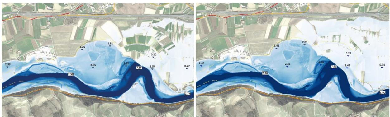
**Figura 3 – Estratto dell'Elab. 2.8 – Planimetria aree di esondazione in condizioni di piena – stato di fatto (a sinistra) e dell'Elab. 2.9 – Planimetria aree di esondazione in condizioni di piena – stato di progetto (a destra)**
