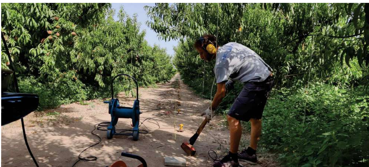
Energizzazioni con mazza battente onde longitudinali (Onde P e MASW)
