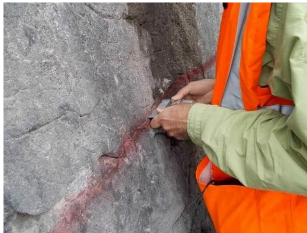
Figura 5. Misura del rimbalzo del martello di Schmidt
