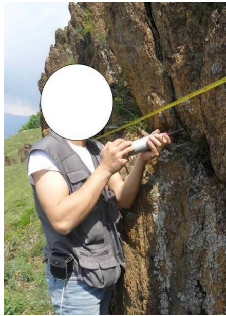
Figura 5. Misura del rimbalzo del martello di Schmidt
