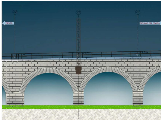
Figura 5 Viadotto Gocciadoro: Portali T.E. e relativo sistema di ancoraggio
