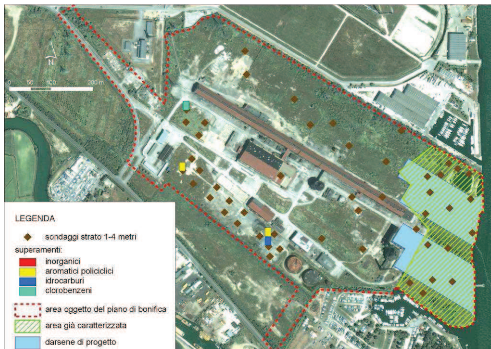
Figura 4-4 Sondaggi disponibili in cui sono stati riscontrati nello strato 1-4 m superamenti dei CSC dell'Allegato 5 al Titolo V del D.Lgs. 152/06 ed indicazione degli analiti con superamento (area retroportuale)
