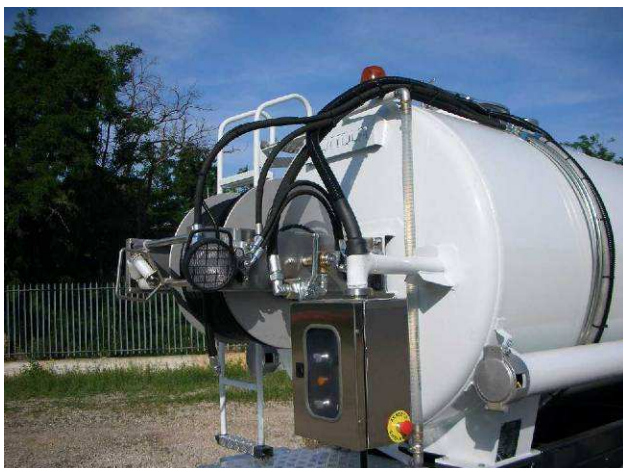
Figura 2 Attrezzatura canal-jet montata su autobotte e naspo idraulico con tubo flessibile per la pulizia delle condotte; la tecnica consiste nei getti d'acqua inviati ad alta pressione tramite un ugello collegato ad un tubo flessibile
