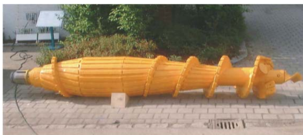
Figura 4-4 – utensile per la realizzazione di pali FDP e fase operativa
