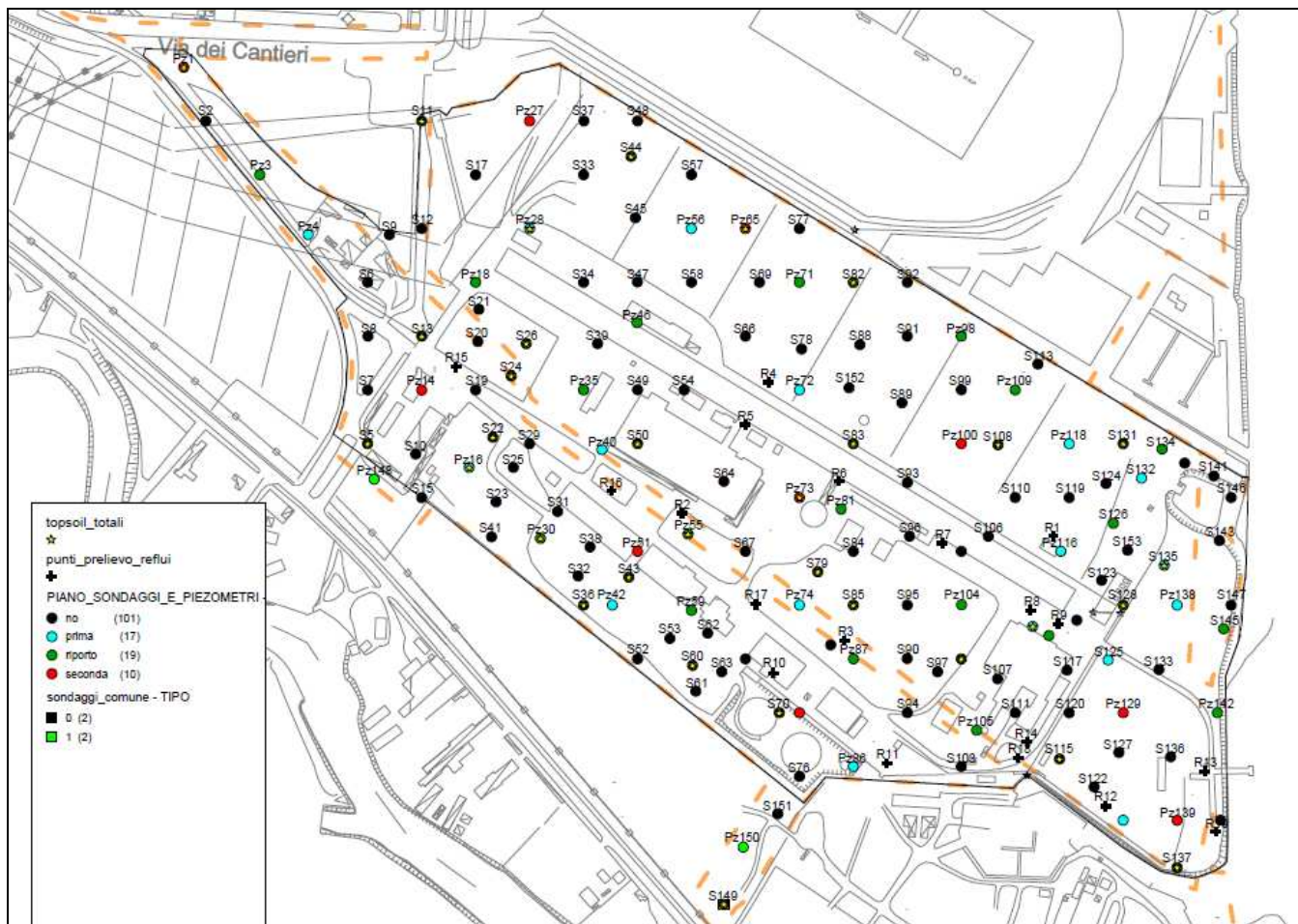
Figura 2-4 Indagini di caratterizzazione di suoli, falde e reflui nei sottoservizi (2009)
