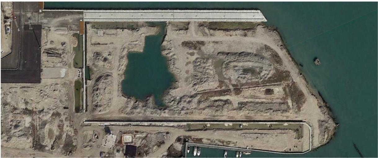
Figura 4-2 – Completamento opere di marginamento e coronamento darsena sud – fonte Google Earth 03/2015 – scavo e dragaggio da realizzare
