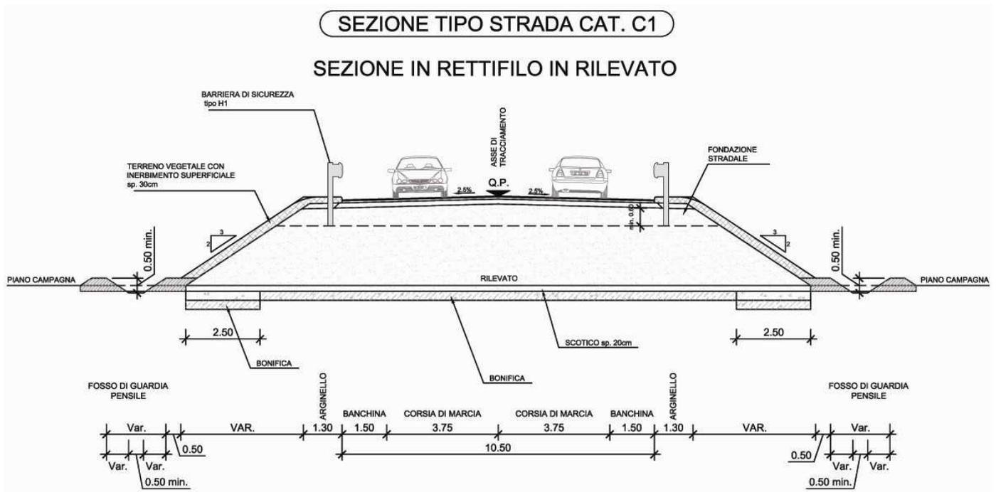
Figura 2.3 Sezione tipo C1 in rettilineo
