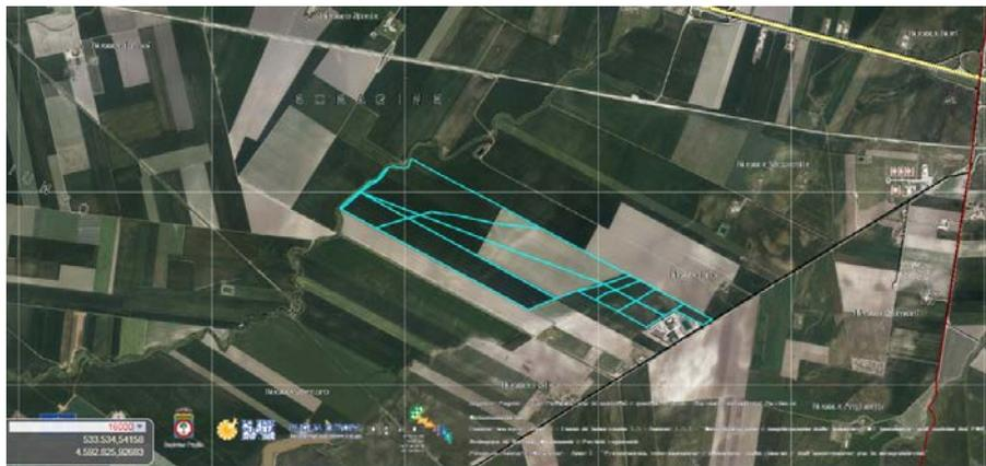
In riferimento al percorso di collegamento alla sottostazione 30/150kV in località "Palmori", il cavidotto sarà interrato alla profondità superiore al metro.
