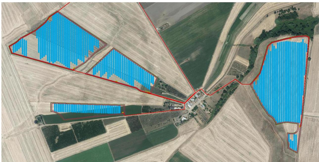
Figura 2.4a. – Area di progetto con indicazione del posizionamento dei moduli fotovoltaici su ortofoto.
