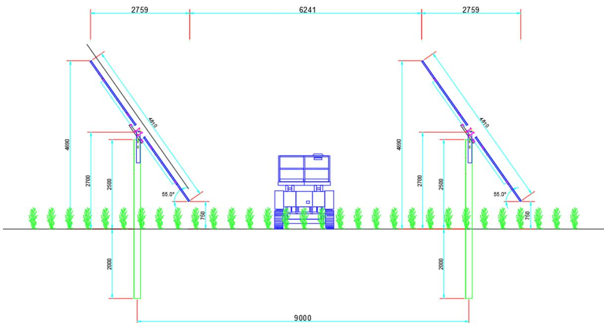
Figura 2.2. – Area di insidenza minima del modulo fotovoltaico.
