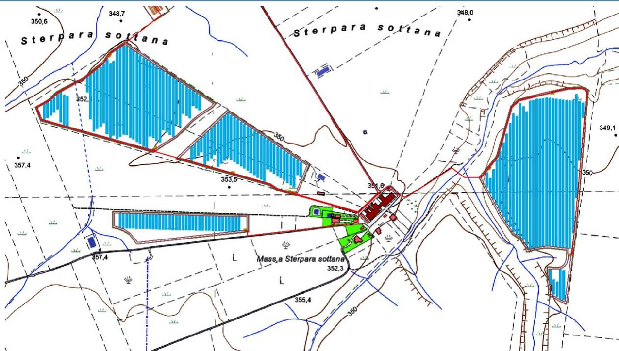
Figura 2.4b. – Area di progetto con indicazione del posizionamento dei moduli fotovoltaici su CTR.
