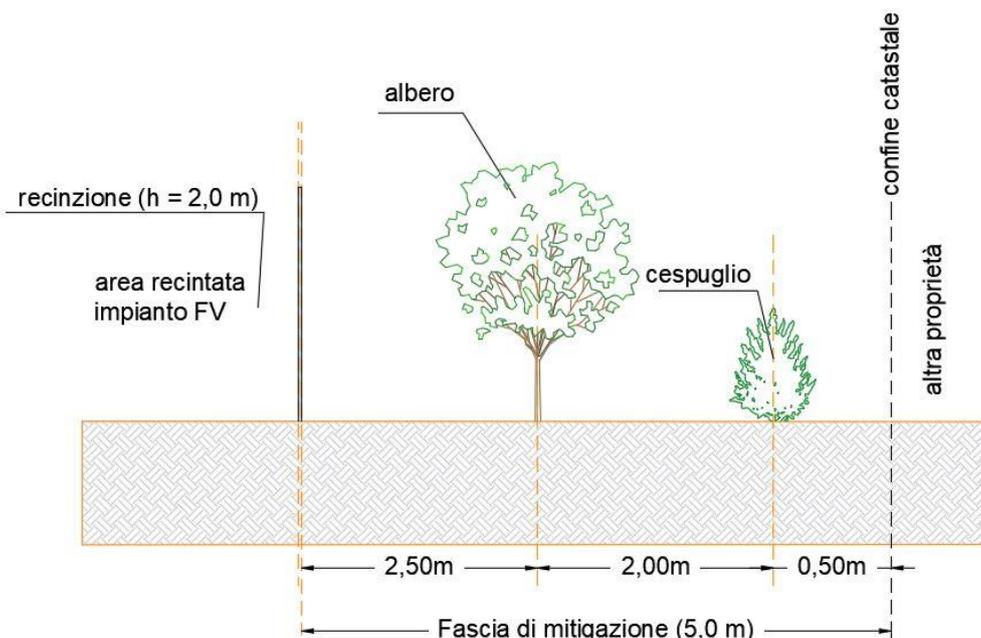
Figura 4.3. – Stralcio di sezione dell'area perimetrale dell'impianto.
