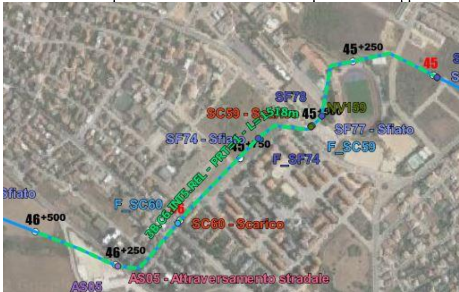
Figura 2.41 – in evidenza il tratto in relining dentro l'abitato del Comune di Porto Torres.
