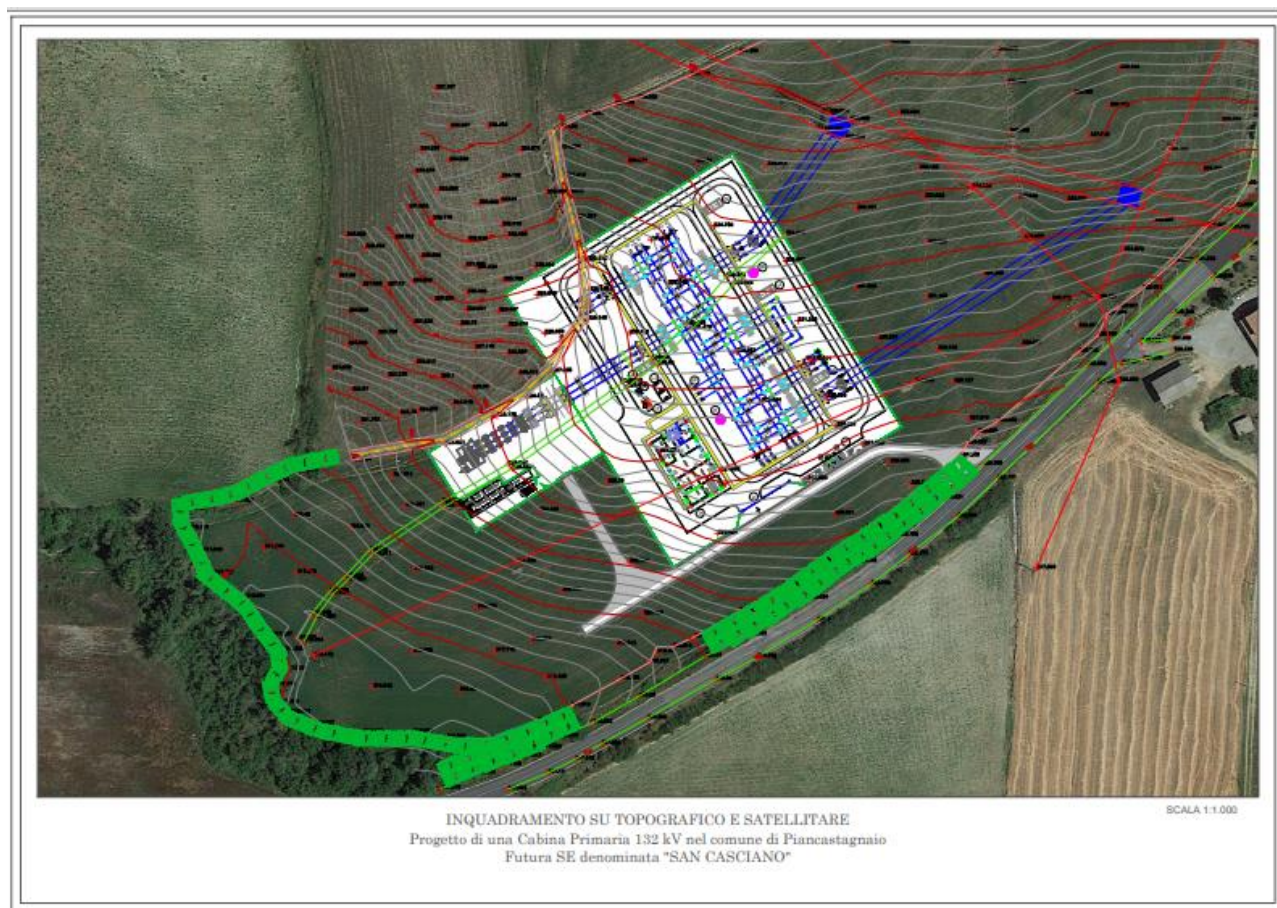
Figura 17: Planimetria nuova Stazione Elettrica San Casciano Dei Bagni con annessa Stazione di Elevazione utente.
