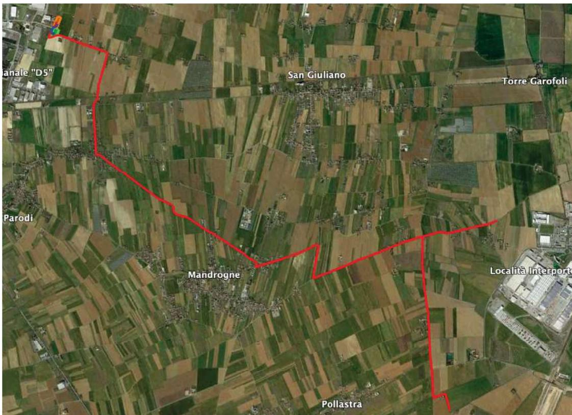
I tratti di cavidotti interrati provenienti dalle cabine generali di parallelo MT presso i sottoimpianti in zona Pantaleona ed in zona Baronina uniranno il proprio tracciato all'intersezione tra strada comunale Bosco e strada Savonesa, in Comune di Tortona.
