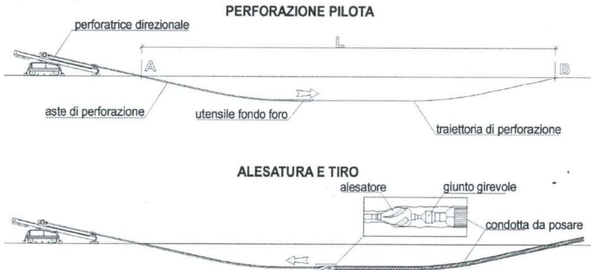
Il tratto di cavidotto in AT tra la sottostazione AT/MT e la cabina di E-distribuzione avrà una lunghezza di 230 m e prevede sezioni di scavo come da schema seguente:
