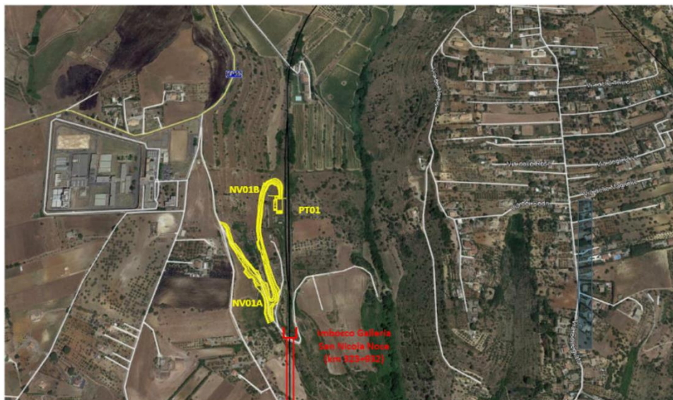
Figura 5: Configurazione di progetto per l'accesso al PM di Piano Carbone e al PE della galleria San Nicola Noce
