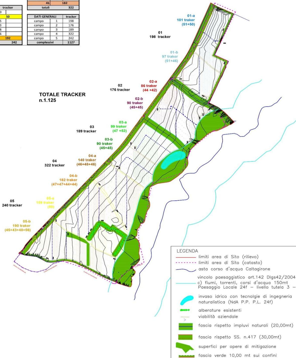
Figura 4: Layout impianto, opere di compensazione e mitigazione, vincolistica e rilievo topografico
