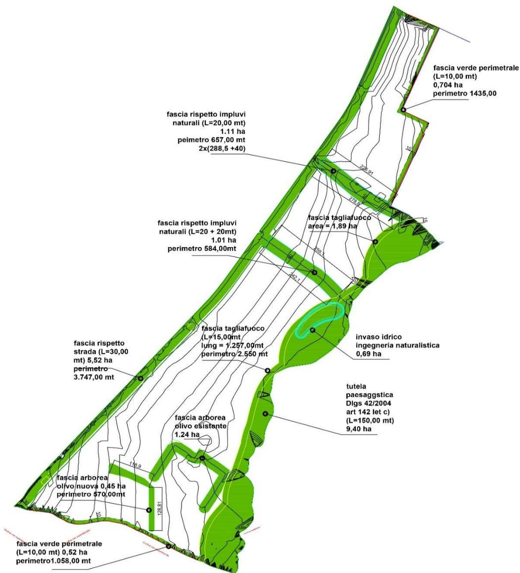
Figura 6 - Superfici per compensazione e mitigazione ambientale su rilievo topografico
