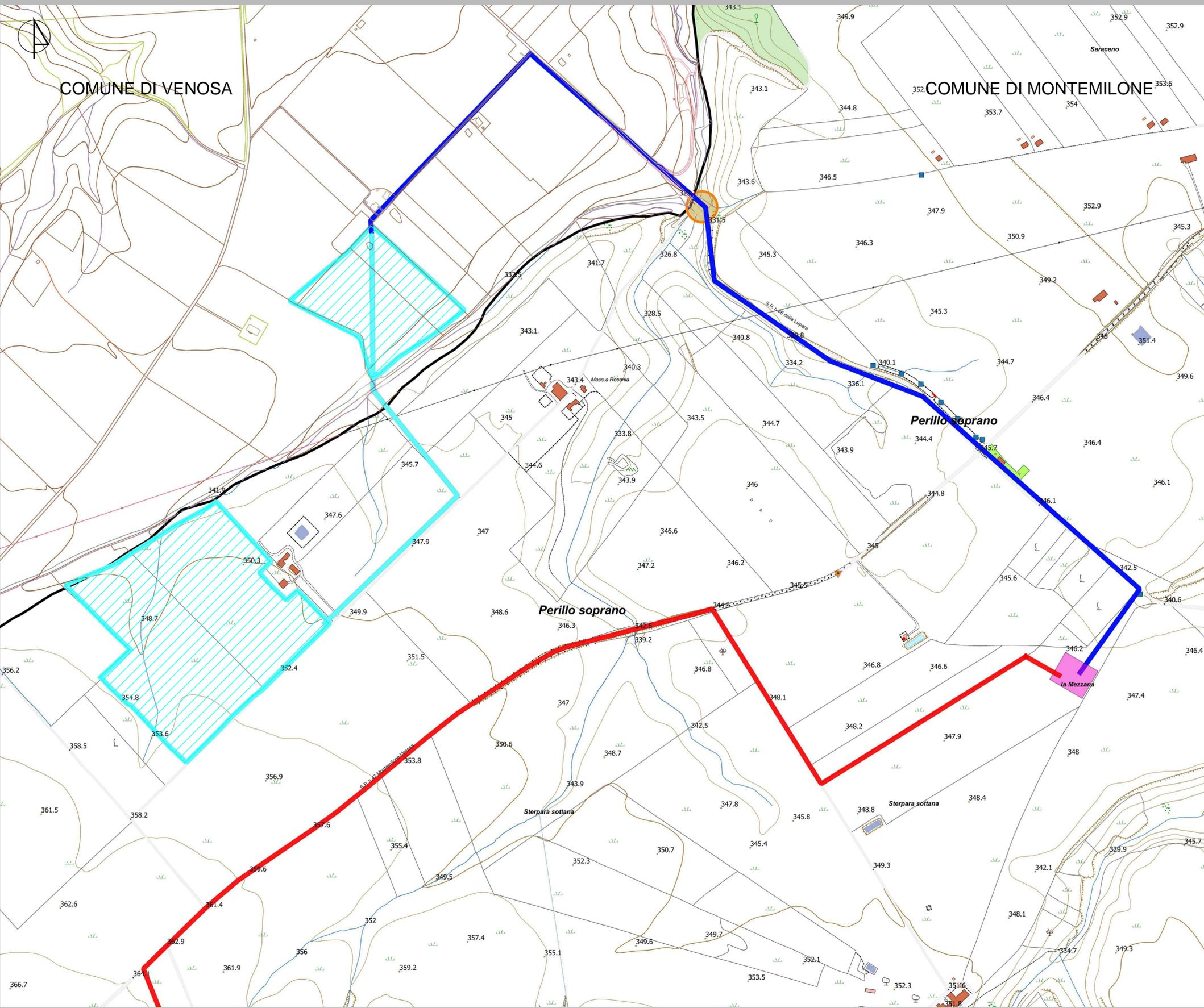
TRACCIATO DEL CAVIDOTTO A 30 kV E SEZIONI DI SCAVO \_ SCALA 1:5000
