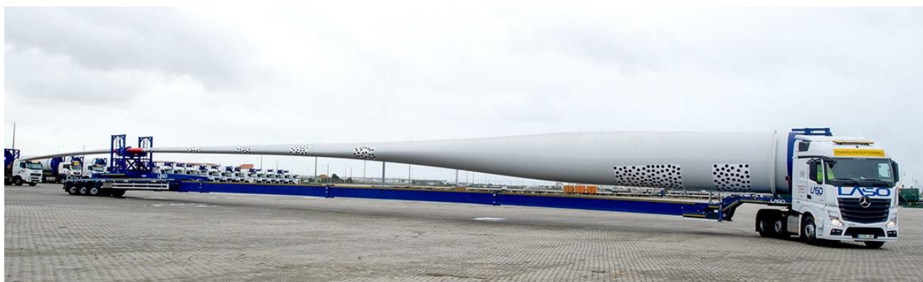
Figura 1 Esempio di trasporto pale con tipologia SWC
