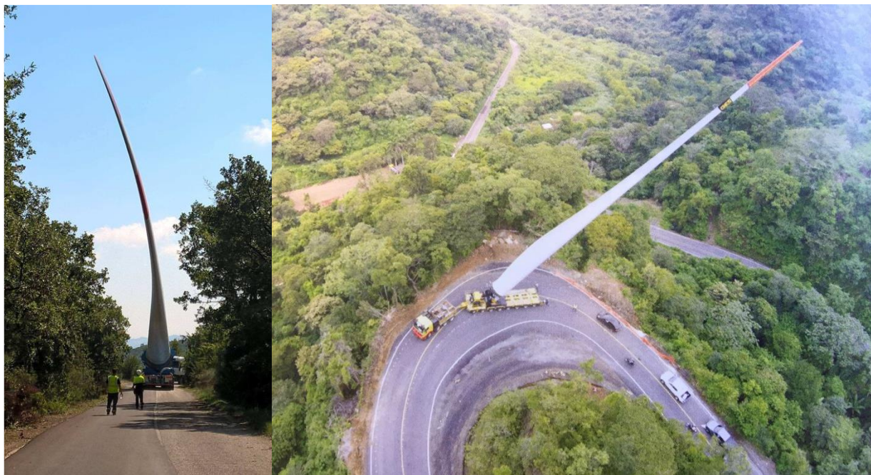
Figura 12 Esempio di trasporto con Blade lifter trailer
