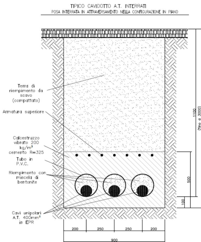
Verrà inoltre posata, a quota di 20 cm al di sopra del bauletto in cemento (rinforzato da un'armatura di protezione superiore), una rete di segnalazione in materiale plastico di colore rosso-arancio con applicato sulla faccia superiore un nastro con la scritta "CAVI a 150.000Volt" (o equivalente). Laddove necessario verrà inoltre posata una palina con targa monitoria, piantata sul terreno a margine del tracciato del cavidotto.
